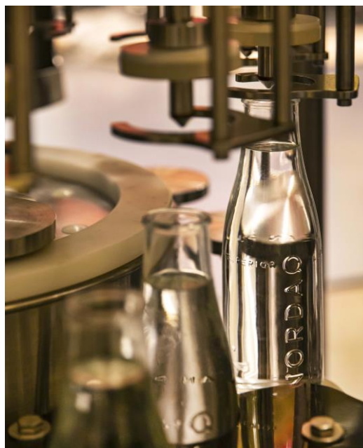
图二：自动化的过滤水装瓶系统每小时可注满 2,000 瓶水，此举措大幅减少因生产、供应及物流过程中所制造的塑胶废料及碳足迹，减低对环境造成的伤害，为酒店行业的未来可持续发展定下新基准。
