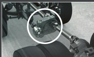
**2** Innerhalb einer halben Sekunde aktiviert eine Klauenkupplung den Allradantrieb während der Fahrt. Folglich kann der Lkw ohne Verlust an Drehmoment oder Geschwindigkeit weiterfahren.
