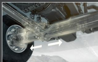
**3** Привод передних колес остается задействованным до тех пор, пока водитель не отпустит педаль акселератора.
