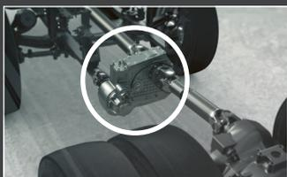
**2** Зубчатая муфта подключает полный привод за 0,5 секунды без необходимости остановки автомобиля. Машина продолжает движение, не теряя ни скорости, ни тяги.
