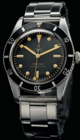
La référence 7923 est équipée du calibre ETA 1182 à remontage manuel battant à 18 000 alternances par heure. Son bracelet à maillons rivetés est de type Oyster, référence 6636, et porte une signature Rolex. Deux attaches droites cylindriques remplaçant sur l'exemplaire présenté ici les fixages incurvés communs, le maintiennent au boîtier.
