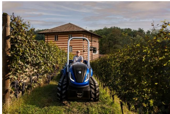
Prototype de tracteur viticole à chenilles New Holland TK Methane Power
