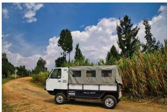
Despachado embalado, o Caminhão Elétrico OX tem carga útil de 1.800 kg e volume de 8,8 m<sup>3</sup>, podendo operar em terrenos e pisos de condições adversas.
