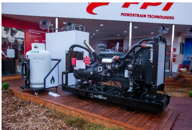
Gerador movido a Biometano e Gás da FPT Industrial
