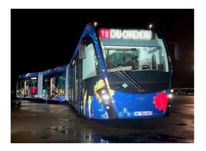
Os motores FPT Industrial Cursor 9 NG para a Van Hool possuem 'Start & Stop', uma tecnologia que desliga o motor térmico quando o veículo se aproxima do ponto de ônibus. Isso
