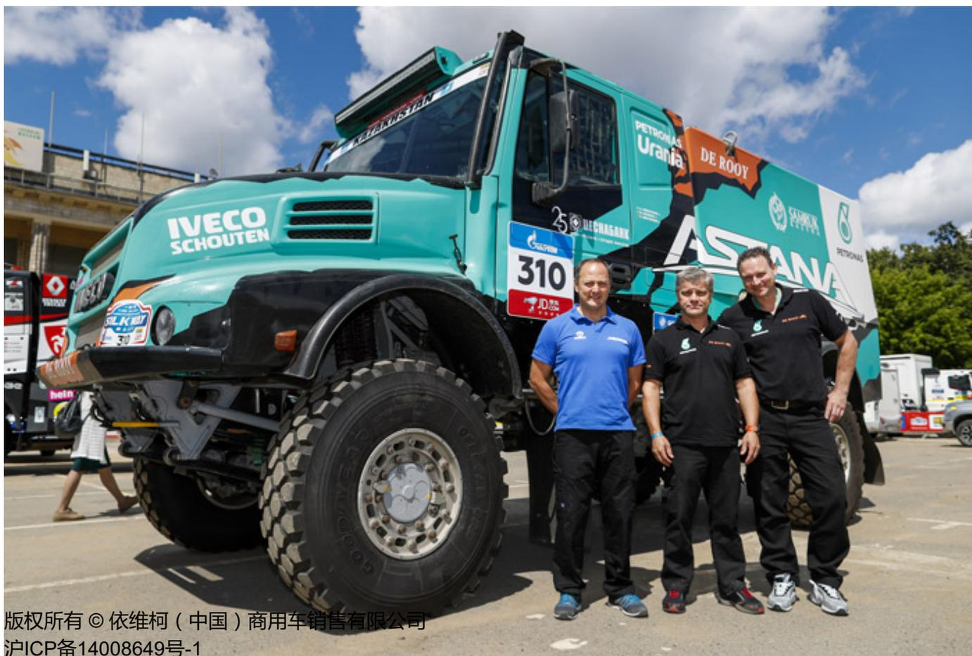
作为车队的最新成员，他将驾驶依维柯 Powerstar 参加比赛，赛车功率达 900 马力，配备 8 档 ZF 变速箱，搭载 IVECO Cursor 13 发动机，在 1200 转/分时最大输出扭矩可达到 3600 牛米。这是车队中的第二台 Powerstar，另一台则由 PETRONAS De Rooy 依维柯车队的队长驾驶。
