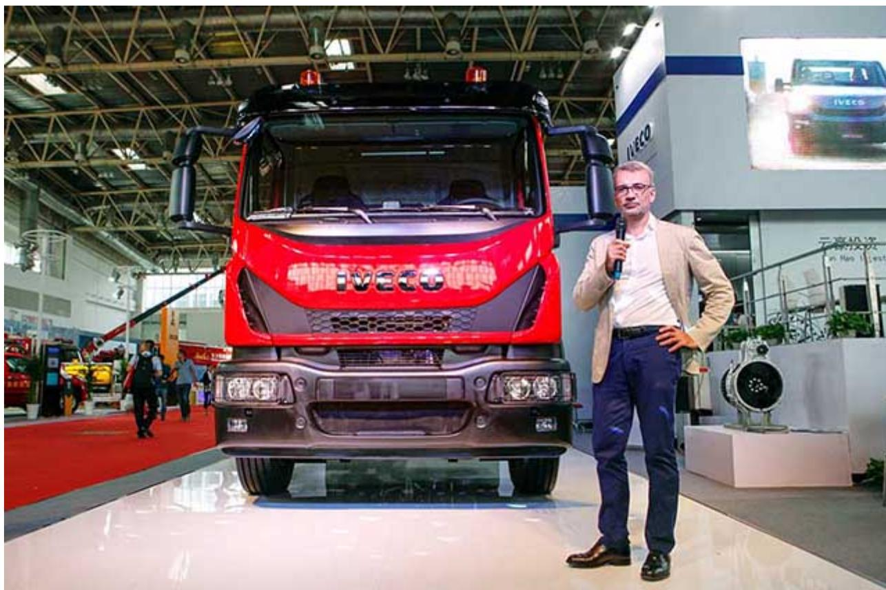
New Eurocargo经过了彻底地重新设计，整车造型焕然一新。外型设计，全新侧扰板与前脸设计相得益彰，不仅令整车造型更具时尚感，还降低了2%的风阻系数，使得油耗进一步降低。舒适性设计，使得功能性和人机工程方面表现更优异。驾驶室围绕驾驶员采用全新布置，简洁明了，仪表台上的控制按钮触手可及。座椅面料采用熔织工艺，高品质材料和工艺既时尚又耐用。此外，还可以根据客户需求选装空气悬挂驾驶座椅，采用双密度内饰材料，带加热和通风功能，并可选装扶手，提供极致舒适。
