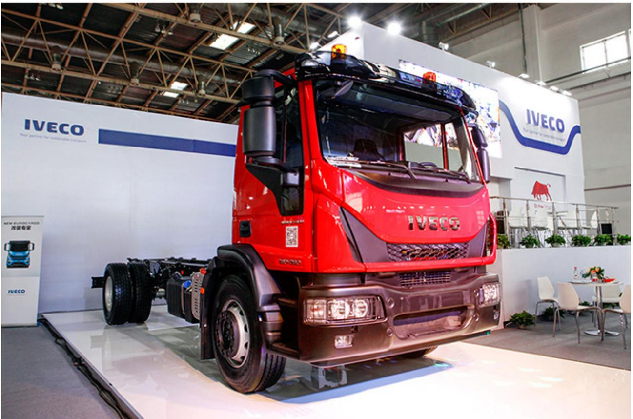
为了更好的满足消防车的需要，New Eurocargo搭配了InterpumpHydrocar进口意大利全功率取力器，可直接从发动机取力，最大持续输出功率157KW，最大扭矩达720牛·米，可匹配大流量水泵。
