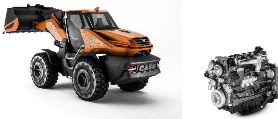
Das TETRA-Projekt – ein Methan-betriebener CASE-Radlader und ein 6-Zylinder-Erdgasmotor von FPT Industrial
