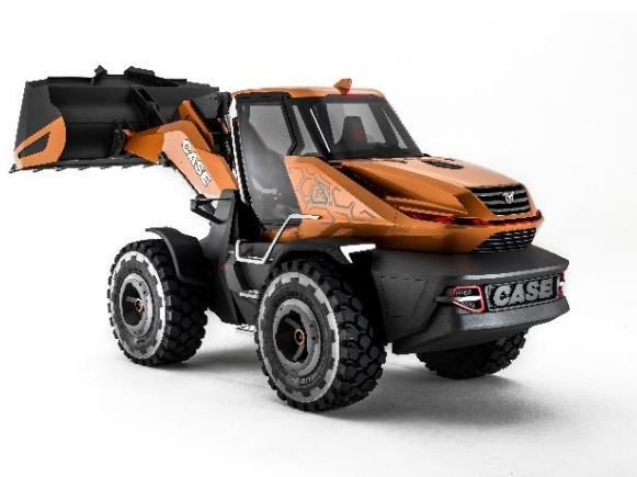
Le concept de chargeuse sur roues à méthane CASE Tetra Project et le moteur GN 6 cylindres FPT Industrial
