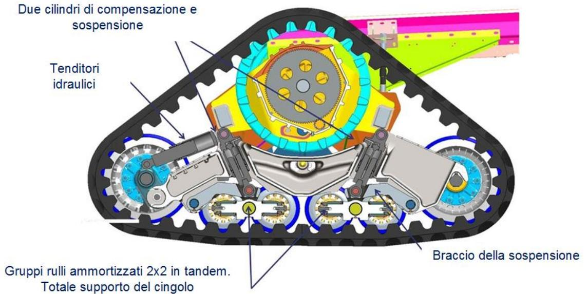
Grazie alla configurazione 'a triangolo' con i rulli a sospensione idropneumatica, la ruota motrice e le due ruote di tensionamento rialzate è garantito il massimo comfort di marcia.
