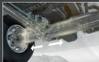
**3** La transmission sur l'essieu avant reste enclenchée jusqu'à ce que le conducteur relâche l'accélérateur.
