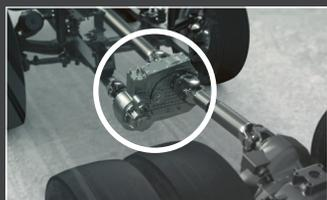
**2** En seulement une demi-seconde, un embrayage griffes active la transmission intégrale alors que le véhicule est encore en mouvement. Le véhicule peut ainsi poursuivre sa progression sans perdre de couple ou de vitesse.
