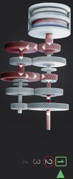
Al conducir, se acciona la primera marcha mediante uno de los ejes primarios. Al mismo tiempo, el otro eje primario preselecciona la siguiente marcha.
