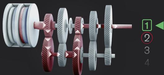
Al conducir, se acciona la primera marcha mediante uno de los ejes primarios. Al mismo tiempo, el otro eje primario preselecciona la siguiente marcha.
