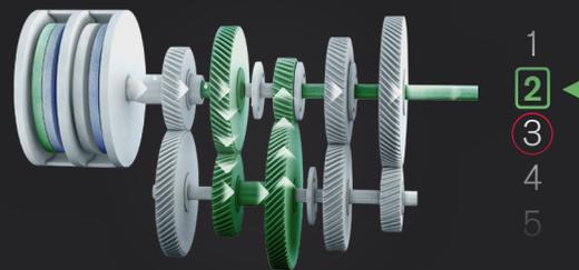
Beim eigentlichen Gangwechsel wird die zuvor eingekuppelte Kupplung aus- und gleichzeitig die ausgekuppelte Kupplung eingekuppelt. All dies geschieht ohne Drehmomentverlust.
