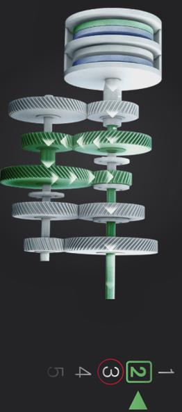
Beim eigentlichen Gangwechsel wird die zuvor eingekuppelte Kupplung aus- und gleichzeitig die ausgekuppelte Kupplung eingekuppelt. All dies geschieht ohne Drehmomentverlust.
