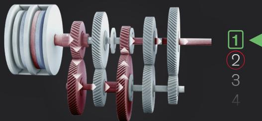
Beim Fahren wird von einer der Antriebswellen der erste Gang eingelegt. Gleichzeitig wählt die andere Antriebswelle den nächsten Gang aus.
