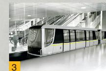
**Pfeilschnell:** Das Personentransportsystem (PTS) verbindet Satellit und Terminal 2 über zwei 400 Meter lange unterirdische Tunnel. Die Fahrtzeit beträgt gerade einmal eine Minute.
