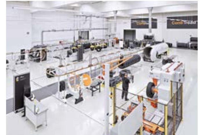
Saubere Produktion: Das weltweit einzigartige Werk nimmt mit seinem integrierten Ansatz aus Heiß- und Kaltrunderneuerung für Lkw- und Busreifen und der eigens entwickelten Gummirecycling-Anlage im Industriemaßstab eine Vorreiterrolle ein.
