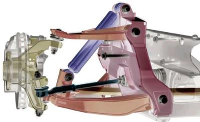
La nuova **sospensione anteriore QUAD-LEAF** è basata su uno schema a doppio quadrilatero con balestra trasversale e consente di raggiungere risultati eccellenti in termini di contenimento degli ingombri e delle masse. Questa nuova sospensione anteriore, standard per tutti i modelli fino a 3,5 tonnellate, si presenta come la migliore sintesi tra le caratteristiche delle due precedenti versioni grazie ad alcune caratteristiche:
