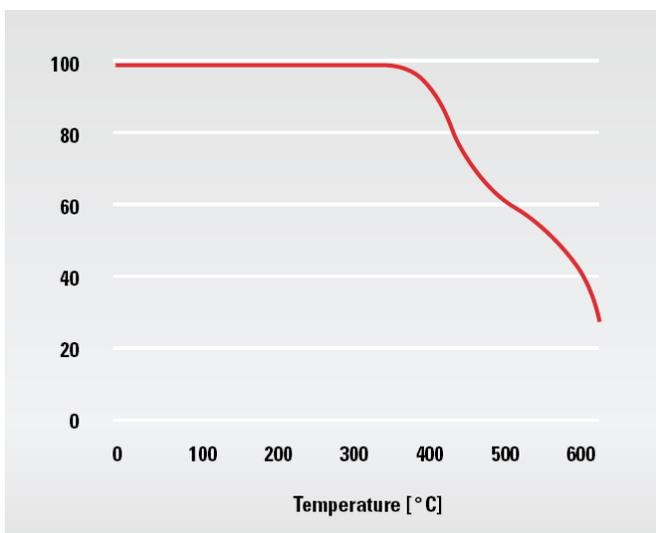
Die thermogravimetrische Analyse (TGA) von Epoxidharzen mit integrierter Flammschutz-ausrüstung aus reaktivem Exolit EP zeigt die ausgezeichnete Wärmestabilität des halogenfreien Flammschutzmittels. (Foto: Clariant)
