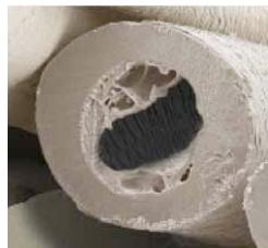
「climaheat」は、糸の中が空洞となった中空構造のホロファイバーを素材に採用。糸の中に空気を溜め込むことで優れた保温効果を発揮。さらに軽さも備えています。
